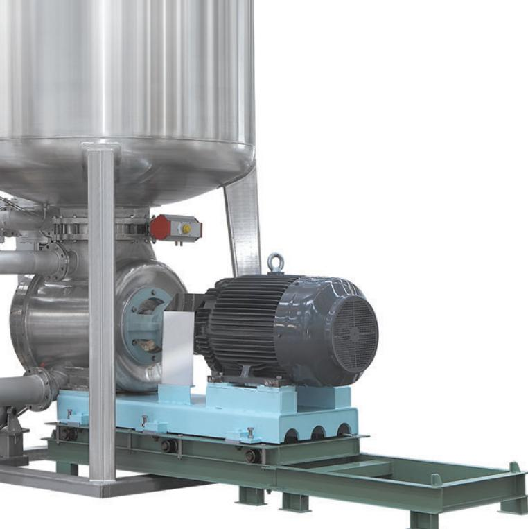
طراحی حداقل نسبت محلول، نیاز به عملیات‌های آبی، خنک سازی آب، بخار دهی، مواد شیمیایی، رنگدانه‌ها و انرژی الکتریکی را به مقدار قابل ملاحظه‌ای کاهش می‌دهد. هیچ گونه لوله کشی لازم نیست و افت جریان به خاطر اصطکاک در لوله کاهش می‌یابد که این باعث افزایش راندمان جریان می‌شود. نسبت محلول ۴~۶:۱ می‌باشد.
